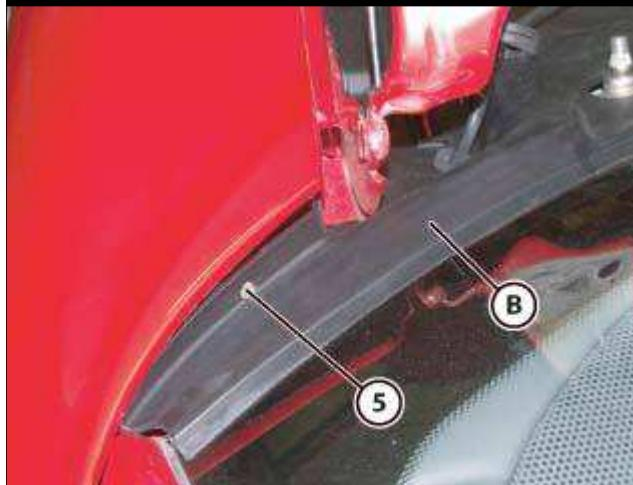
● 安装左侧护罩 (B) 并通过拧紧螺钉 (5) 紧固。
