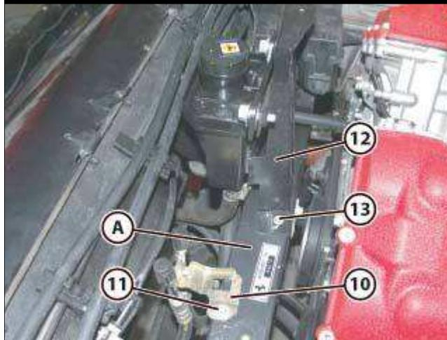
● 通过松开螺钉 (11) 从杆 (A) 上拆卸空调加注管固定架 (10), 然后将其移开, 使它不干扰后续操作。
