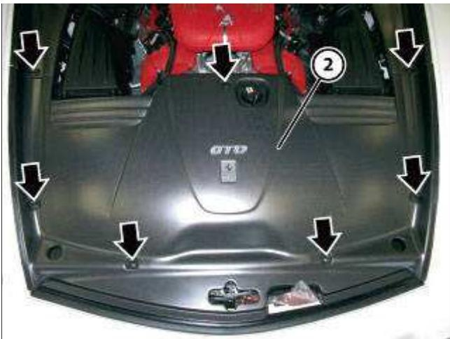
● 要拆卸中央护罩 (1), 松开指示的螺钉。
