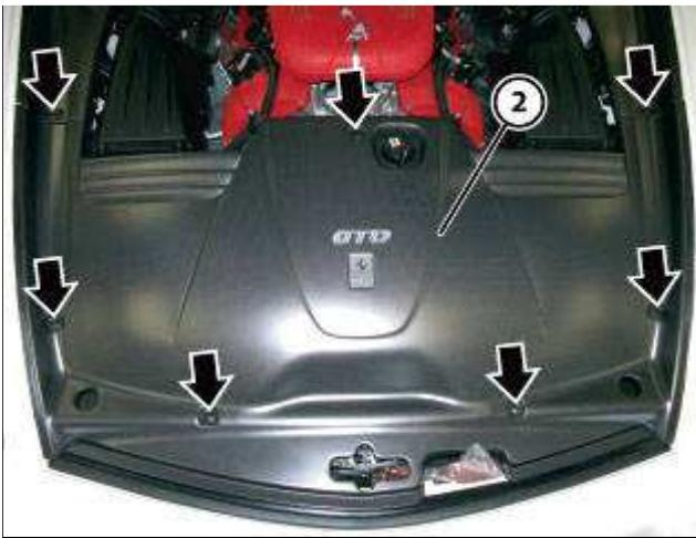
■ 安装中央护罩 (1), 安装翼子板护罩下方后部, 确保护罩在所有侧面都与车身等距, 并通过拧紧六个指示的螺钉紧固。
