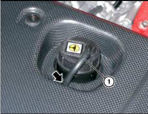
■ 将通风管 (1) 插入指示的孔中, 并连接至盖。
