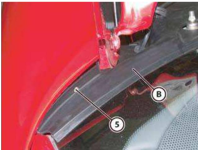
● 安装左侧护罩 (B) 并通过拧紧螺钉 (5) 紧固。
