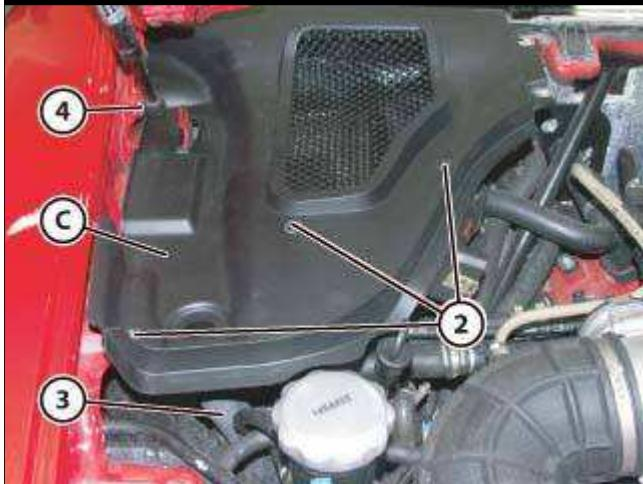
■ 拧紧护罩(C)上的螺钉(2), 连接排放管(3), 定位好气柱固定销, 并将气柱(4)装入其座内。
