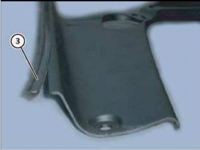
● 一旦壁已拆下, 也可更换壁右侧边缘的密封件 (3)。
